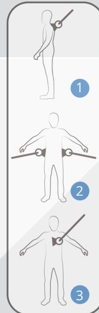
(1) La argolla dorsal se utiliza en sistema anticaídas o restrictivo, (2) las laterales para posicionamiento y (3) la esternal para uso con sistemas de seguridad de escaleras con freno.
